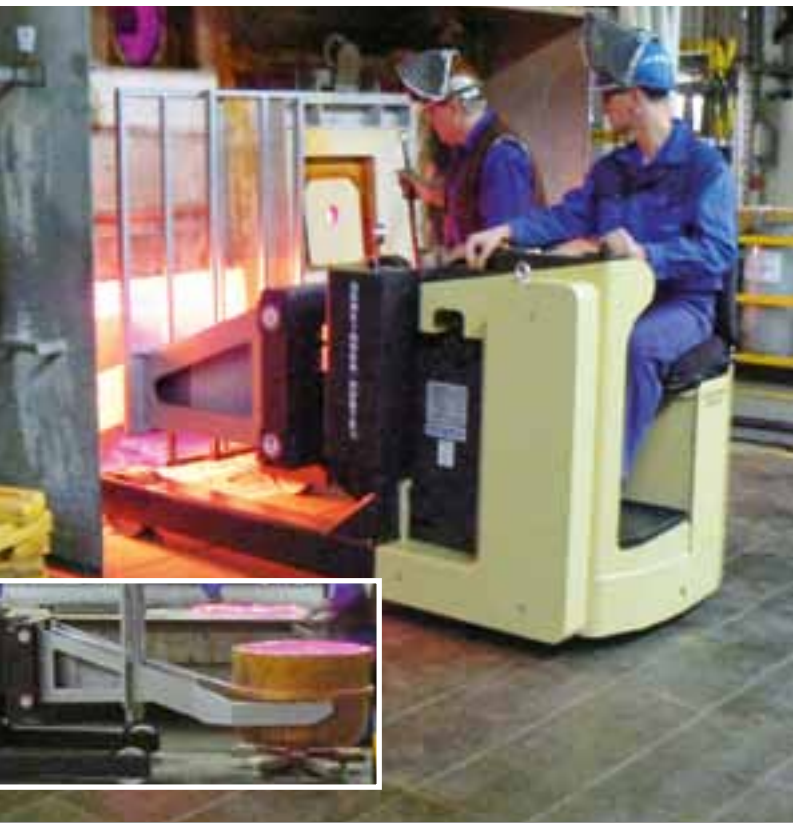
Fahrsitzgerät zum Transport von Tiegeln Sit-down truck for pot transport
