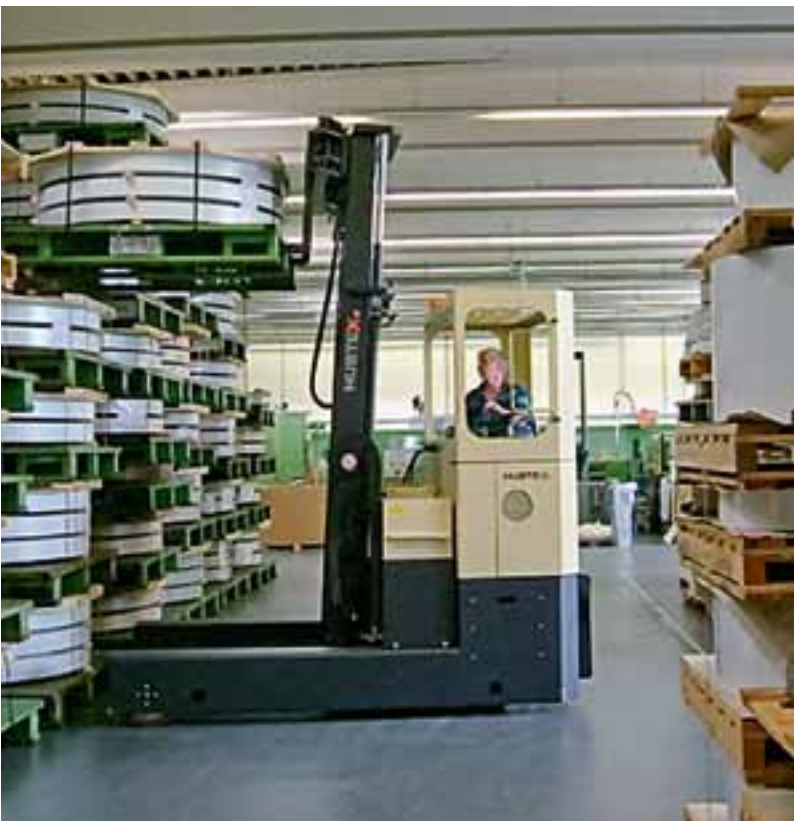
Schubmaststapler mit Tragfähigkeiten 3,5–6 t Reach truck with capacities from 3,5–6 t
