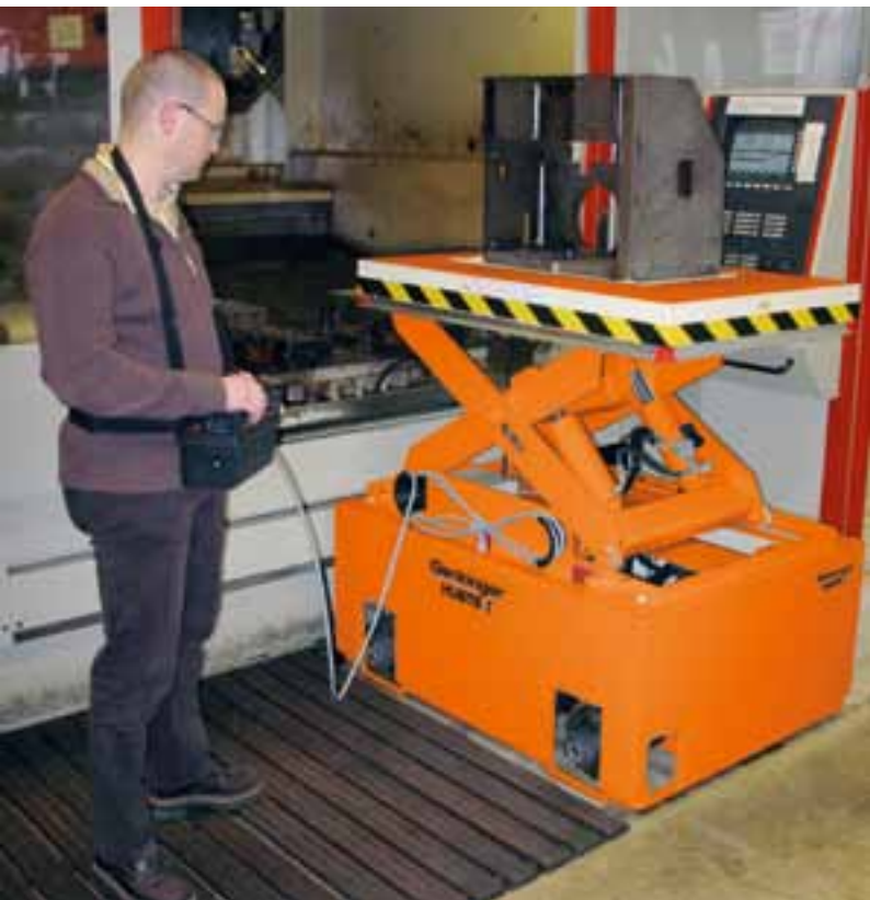
Hubtisch mit Kabelfernbedienung Lift table with cable control
