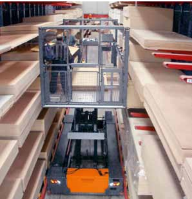
Zweiseiten-Kommissionier-Fahrzeug, Tragfähigkeiten 2–12 t Two-side order picker, capacity 2–12 t
