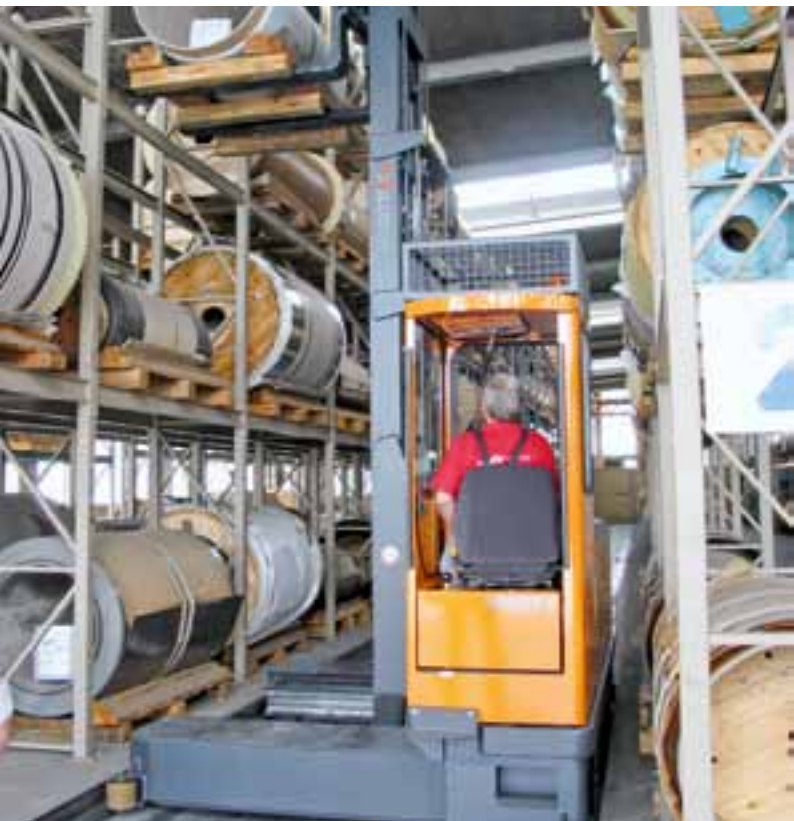
Elektro-Mehrwege-Seitenstapler im Schmalganglager Electric-Multidirectional-Sideloader in narrow aisle application
