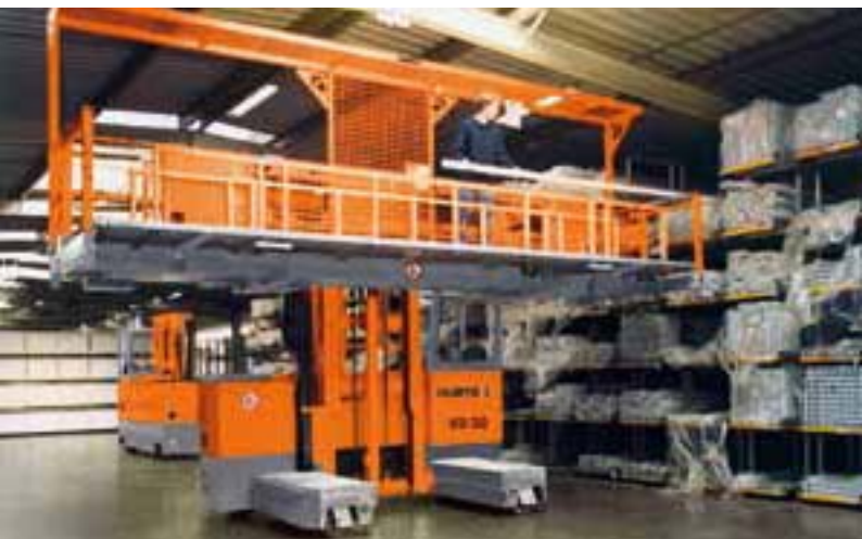
Mehrwege-Seitenstapler mit aufnehmbarer Kommissionierplattform Multidirectional-Sidelaoder with removable order picking platform
