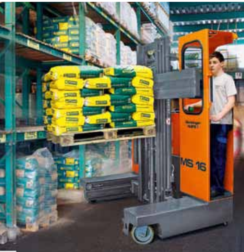
Kompakter Mehrwege-Seitenstapler eingesetzt in Baumärkten Compact Multidirectional-Sideloader working in do-it-yourself stores
