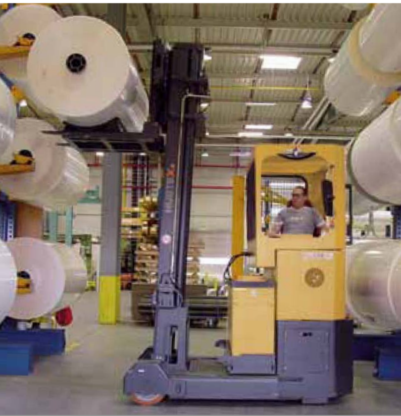
Schubmaststapler für das Handling von Papierrollen, Tragfähigkeiten 3,5–6 t Reach truck for handling of paper rolls, capacities 3,5–6 t
