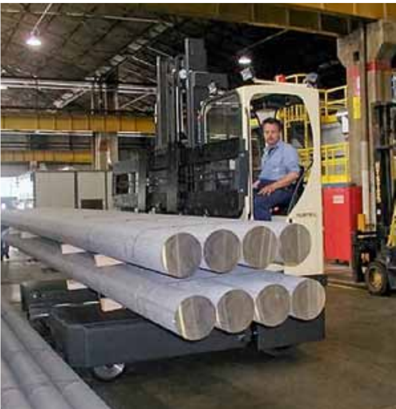
Weichbereifter Elektro-Mehrwege-Seitenstapler Electric-Multidirectional-Sideloader with soft tyres
