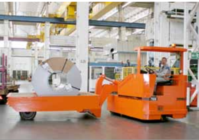
Zugkopf mit Schwanenhals für den Transport von Cargo-Trailern Towing tractor with goose-neck for indoor transport of cargo trailers
