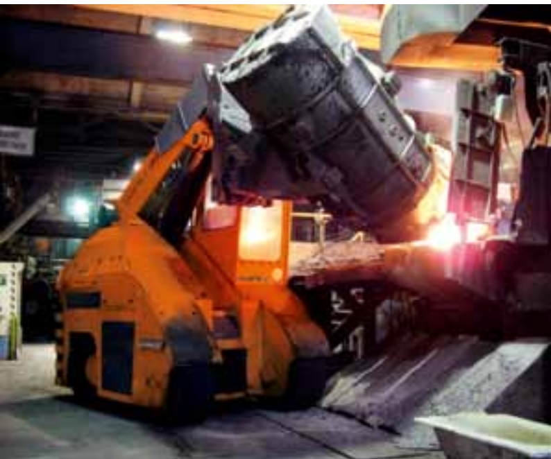
Teleskoparm-Kompaktstapler für das Handling von Konvertern Compact frontlift with telescopic lift-arm for handling of converters
