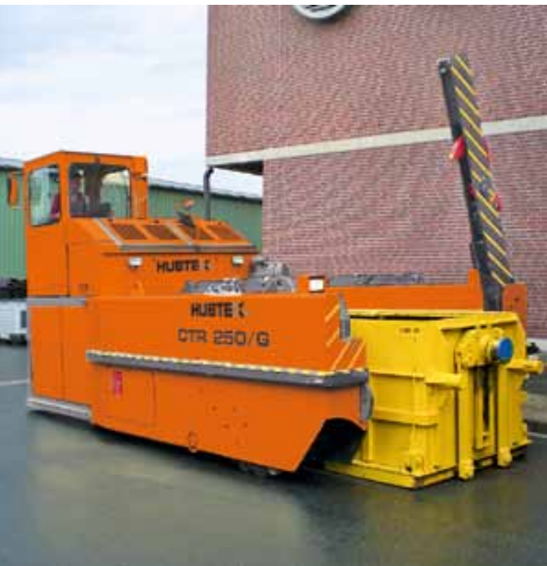
Transporter für Schrott-Container, Tragfähigkeit bis 50 t Transporter for handling of scrap containers, capacity up to 50 t
