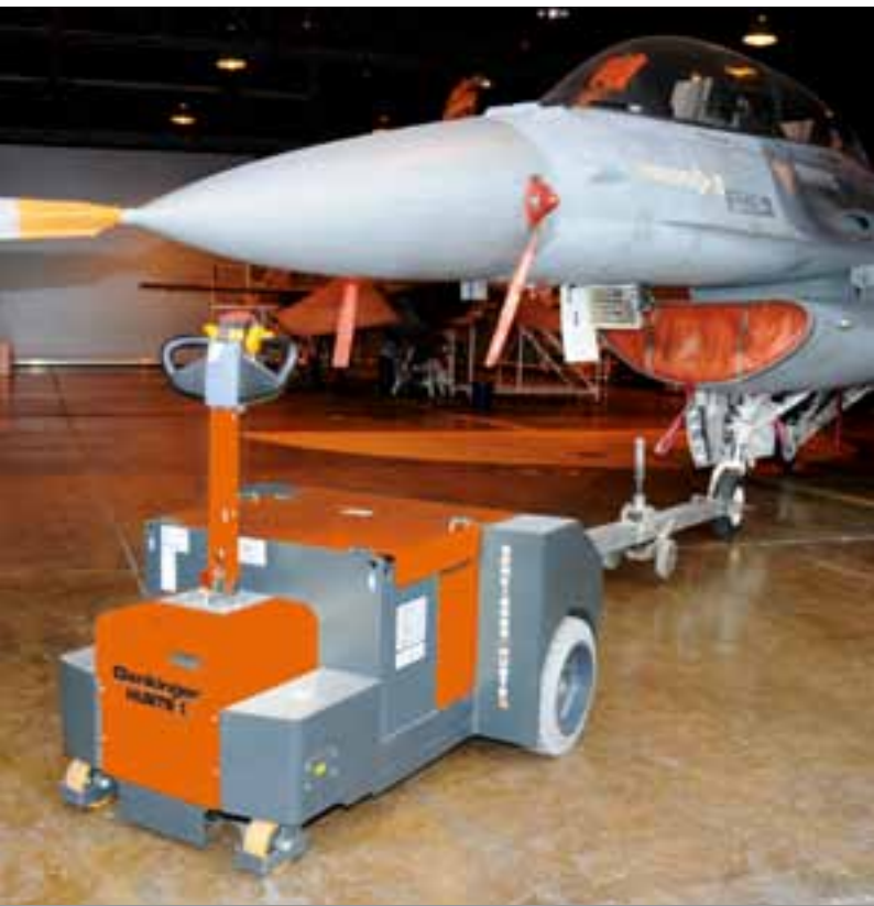
Elektro-Schlepper zum Ziehen von Flugzeugen Electric-powered towing truck for aircrafts
