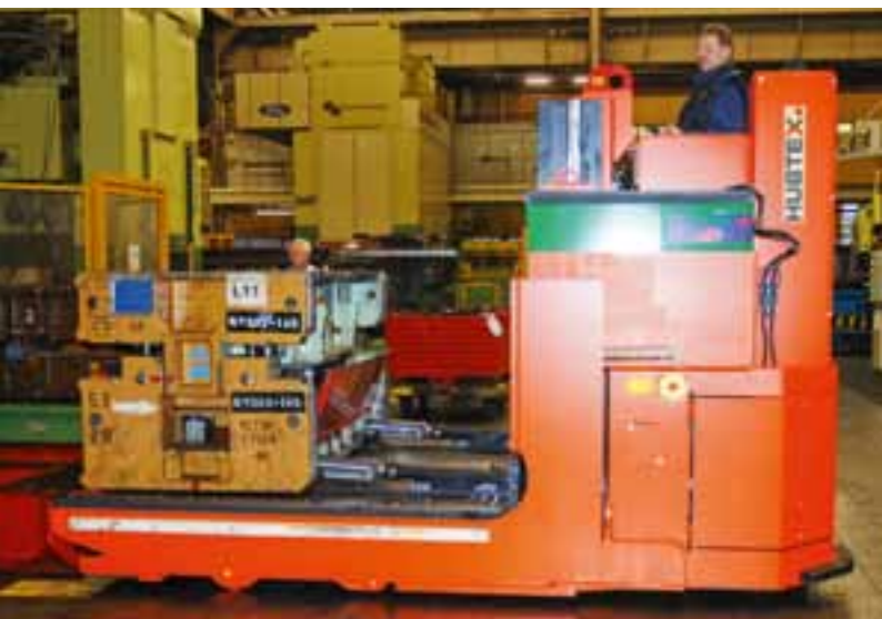
Werkzeugwechsel und -transport innerhalb des Presswerkes Die-change and die-transport in pressing plants
