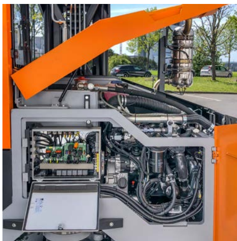
Een geluid geoptimaliseerde turbomotor conform de actuele emissienormen
