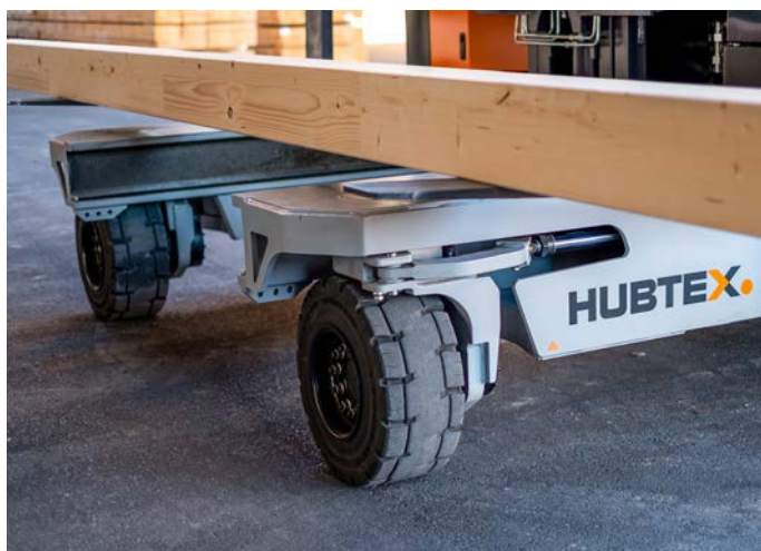
De parkeerrem wordt tijdens het wisselen van de rijrichting automatisch geactiveerd.
