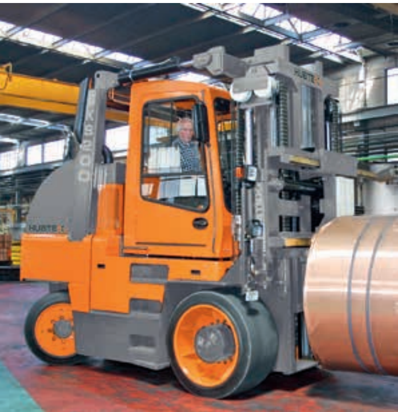
Compacte gasvorkheftruck, draagvermogen 20 t Gas-Kompaktstapler, Tragfähigkeit 20 t
