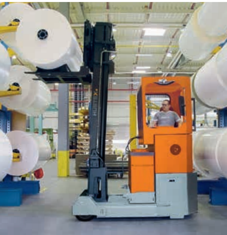
Reachtruck voor de handling van papierrollen, draagvermogen 3,5 – 6 t Schubmaststapler für das Handling von Papierrollen, Tragfähigkeiten 3,5 – 6 t
