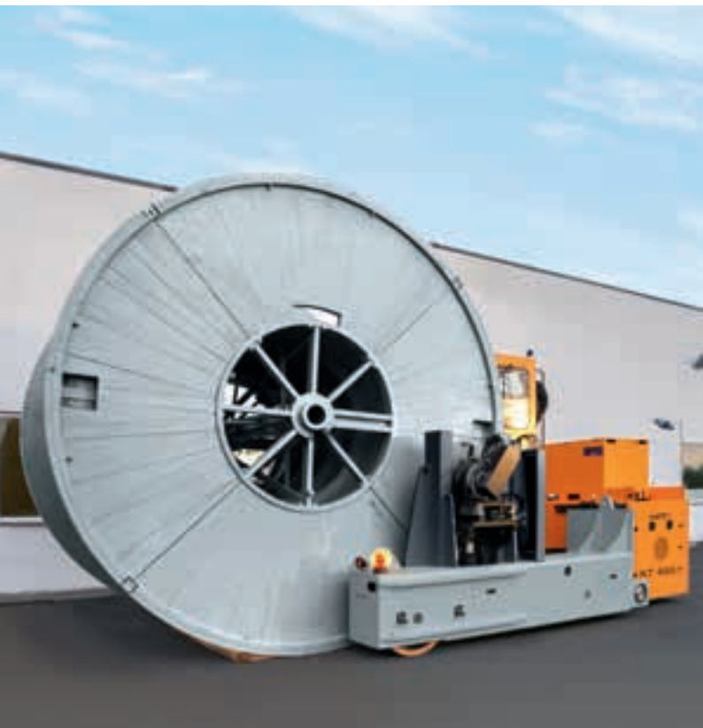
Haspeltruck met 45 t draagvermogen Kabeltrommeltransporter mit 45 t Tragkraft
