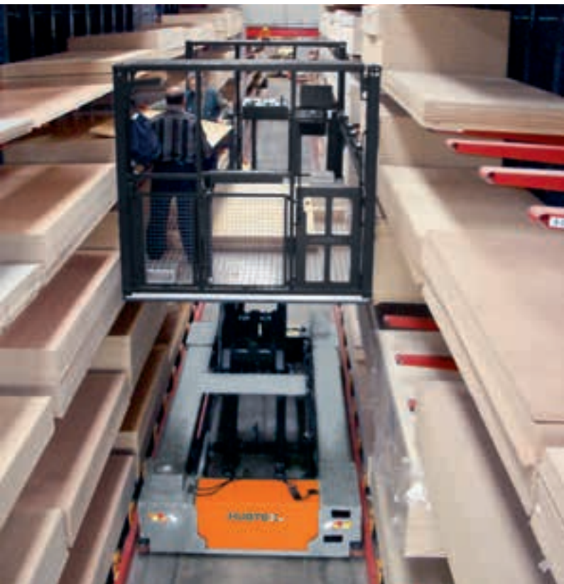
Toestel voor tweezijdig orderverzamelen, draagvermogen 2 – 12 t Zweiseiten-Kommissionier-Plattform, Tragfähigkeiten 2 – 12 t
